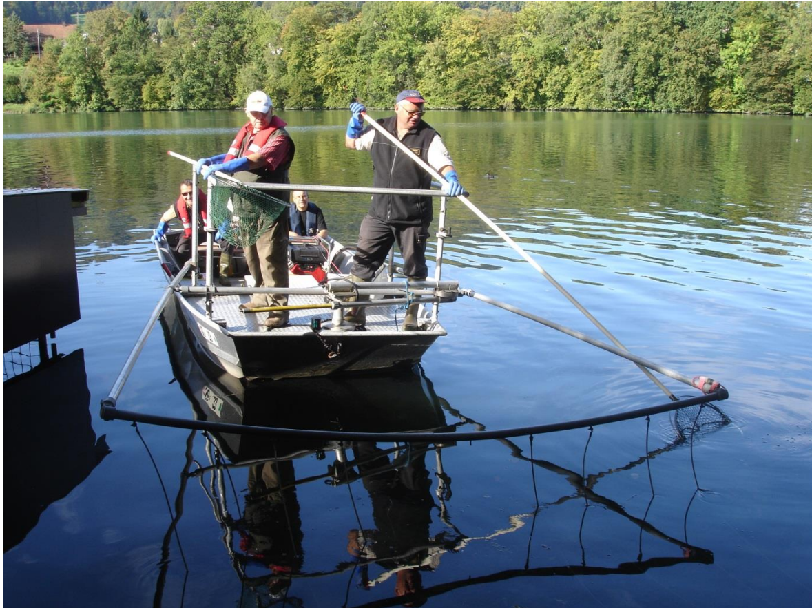
Abb. 4 Fangboot des Kantons St. Gallen mit Anodenrechen.
